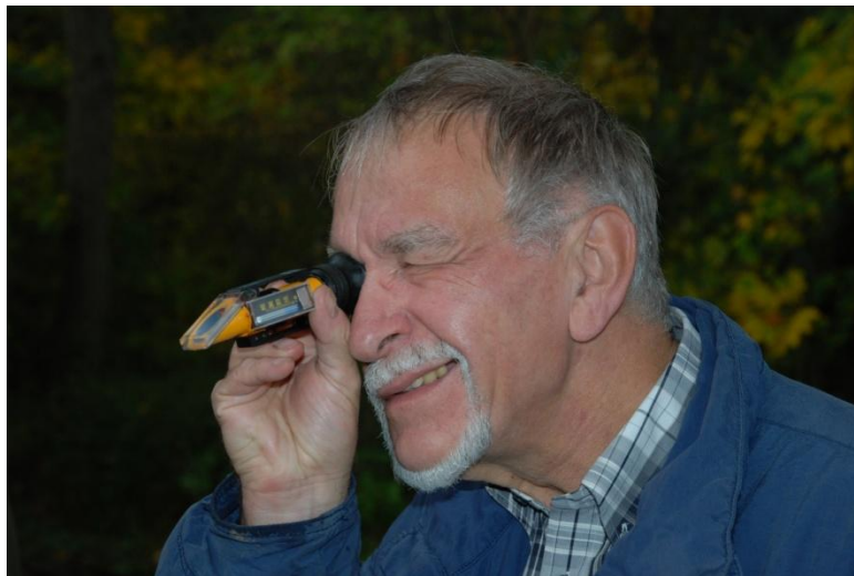
Ermittlung des Oechsle-Grades mit dem Refraktometer
