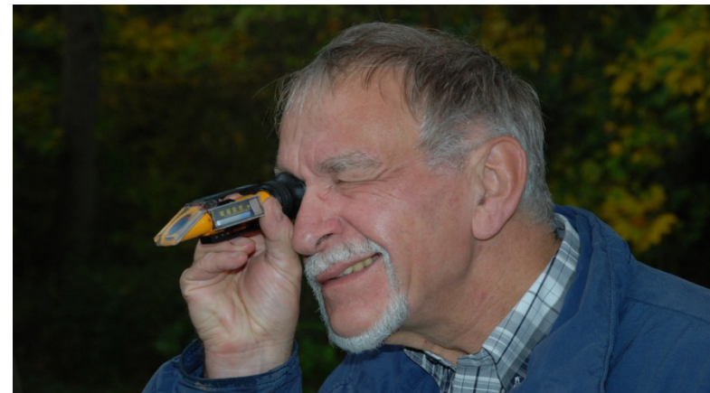
Ermittlung des Oechsle-Grades mit dem Refraktometer
